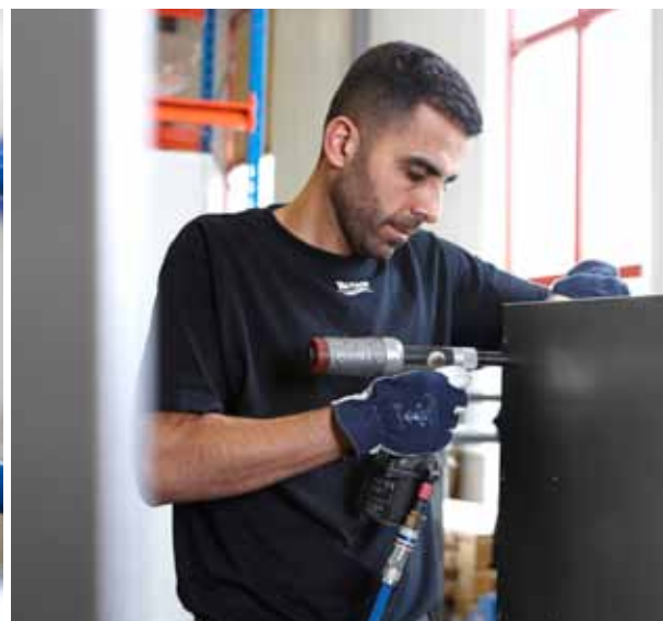
eSafe avluftar slangen innan isärkoppling, vilket kraftigt reducerar ljudnivån samt eliminerar slangrekylen vid verktygsbyte.
